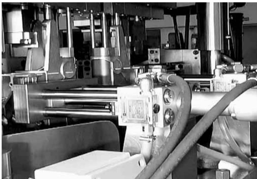
RS 带导向滑杆的油缸在倒角去毛刺工具上的应用
