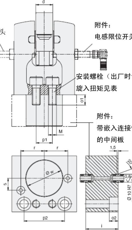
底座上必须有嵌入接头安装孔, 用于暗管连接时的供油。
