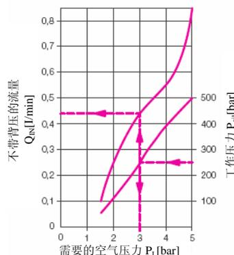
例如:工作压力  $P_{oil}=250\text{bar}$ , 气源压力  $P_L=3\text{bar}$  在前置的气动三联件进行调节。
